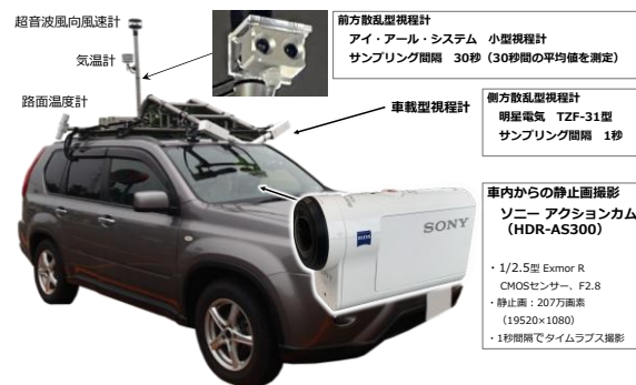
図 1 本研究に用いた視程計とカメラ
