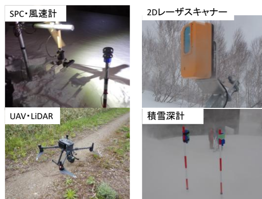
図2 設置した観測機器
