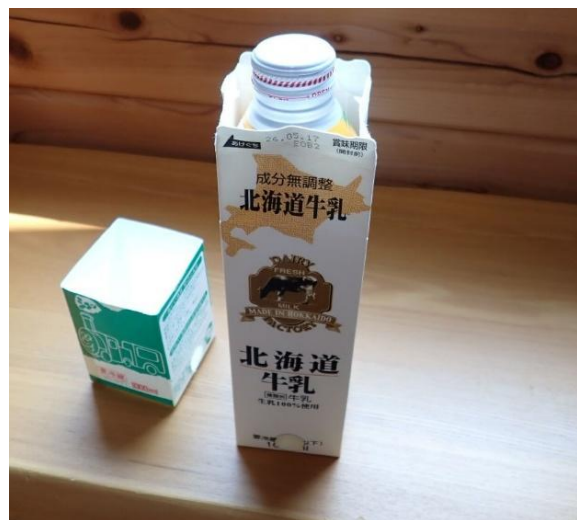
写真5 温熱源（熱湯入りアルミ缶）の挿入
