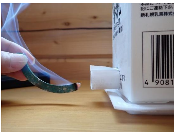
写真3 冷風の吹き出し
