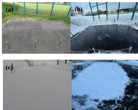
図1 観測対象とした4種類の路面状態 (a)乾燥路面 (b)凍結路面 (c)乾雪路面 (d)圧雪路面
