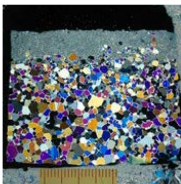
写真 2-03 歩行により氷化した路面の圧雪層．密度は 0.36~0.43 g/cm 3 ．滑らない路面．
